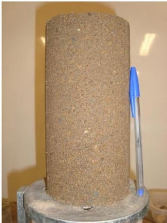
Figura 3. Corpo de prova de solo areno-pedregulhoso.
